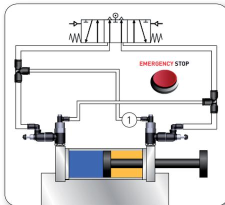
En caso de una parada de emergencia o caída de presión, la presión del piloto (1) desaparece, cerrando las válvulas anti-retorno y bloqueando el bástago del cilindro.
