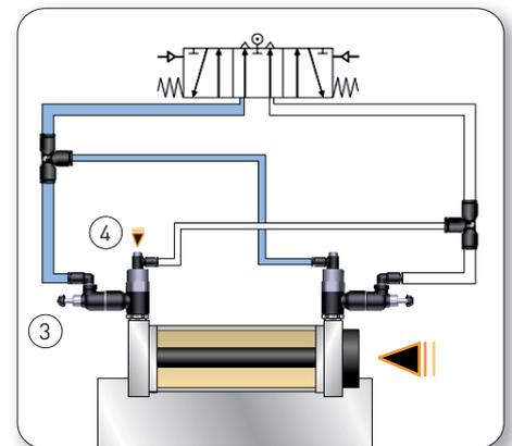
El cilindro se puede activar para volver a la posición de inicio mediante el accionamiento del pulsador (4), eliminando la presión de la cámara a través del regulador de caudal (3) y la válvula de control, siendo así el movimiento controlado.
