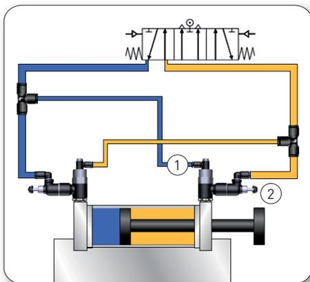
La válvula de control suministra alternativamente a las dos cámaras del cilindro; la conexión del piloto (1) se conecta a la cámara de alimentación opuesta con un racor T. El caudal de escape es controlado por el regulador de caudal (2).
